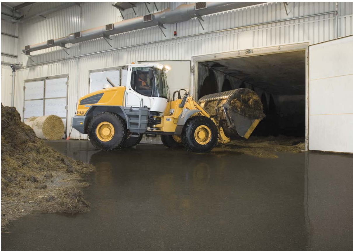
Abbildung 19: Radlader befüllt die Garagenfermenter der Trockenfermentationsanlage Allendorf (Eder).
