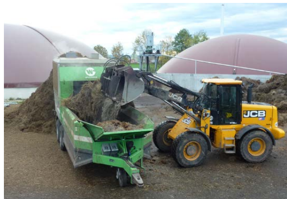
Abbildung 10: Radlader füllt Landschaftspflegematerial zur Zerkleinerung in einen Schnellläufer
