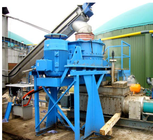
Abbildung 39: Biogrinder – Mechanische Feststoffzerkleinerung der Fa. BHS-Sonthofen
