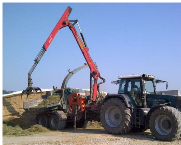
Abbildung 44: Umgebauter Forsthacker im Einsatz zur Zerkleinerung von Landschaftspflegematerial.
