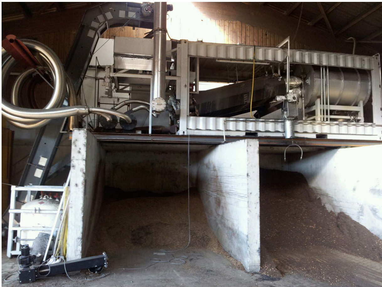
Abbildung 42: Herstellung von Pflanzkohle durch Pyrolyse bei Swiss Biochar.
