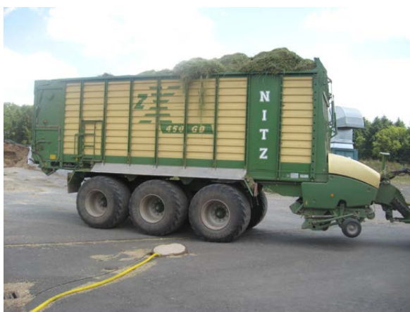
Abbildung 35: Zerkleinerung und Transport des Landschaftspflegematerials mit dem Kurzschnittladewagen.
